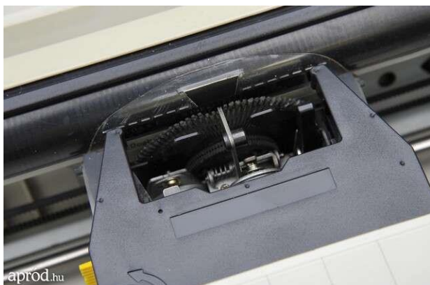
Margarétatárcsás nyomtató képe, és működése.
